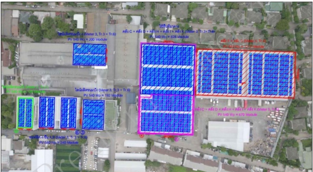
แผนการติดตั้ง Solar Rooftop ที่สำนักงานใหญ่
